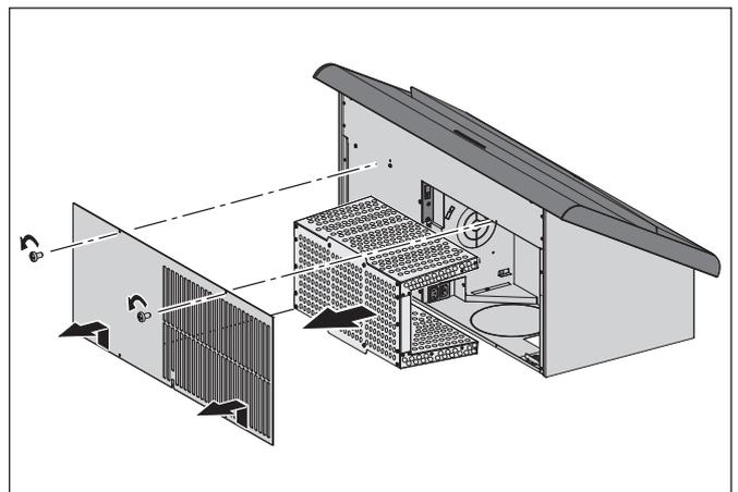
☞ Entfernen Sie die beiden Schrauben.
