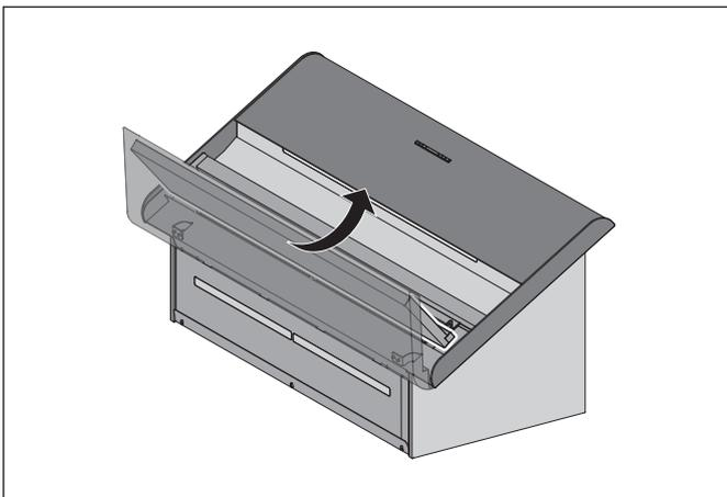
☞ Heben Sie die Unterschale an der Hinterkante an.
