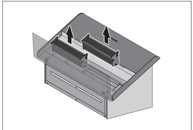
☞ Fassen Sie die Capillar Traps seitlich mit beiden Händen an.
