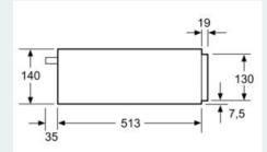
Über eine Wärmeschublade können Kompakt-Backöfen mit einer Gerätehöhe von 455 mm eingebaut werden. Ein Zwischenboden ist nicht erforderlich.
